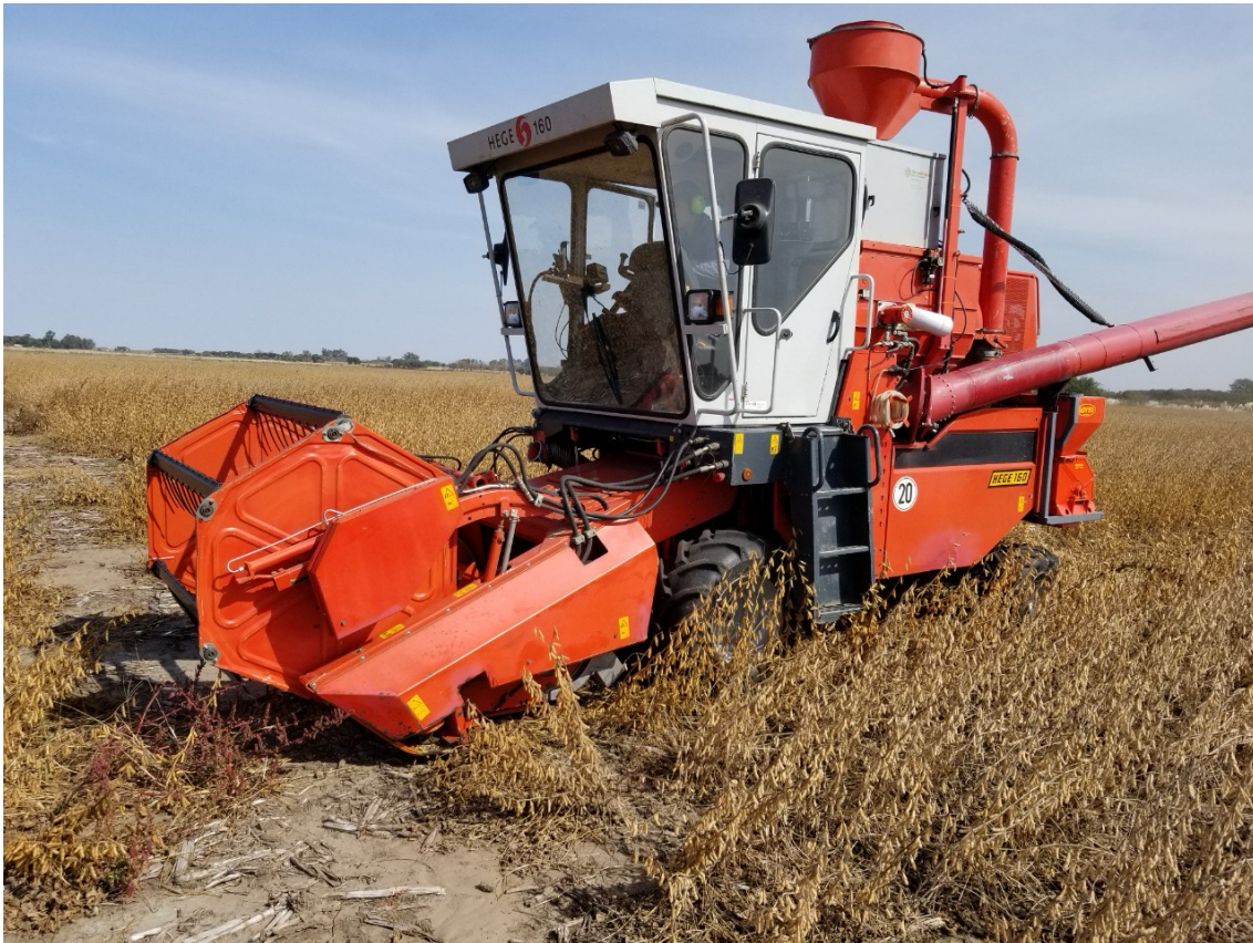
Imagem 1 – Colheitadeira de parcelas experimentais, marca HAGE, modelo HAGE 160
